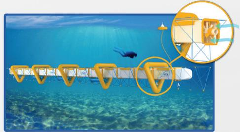
La presión de las olas es transformada en un flujo de agua que atraviesa el ducto, lo que acciona los generadores
